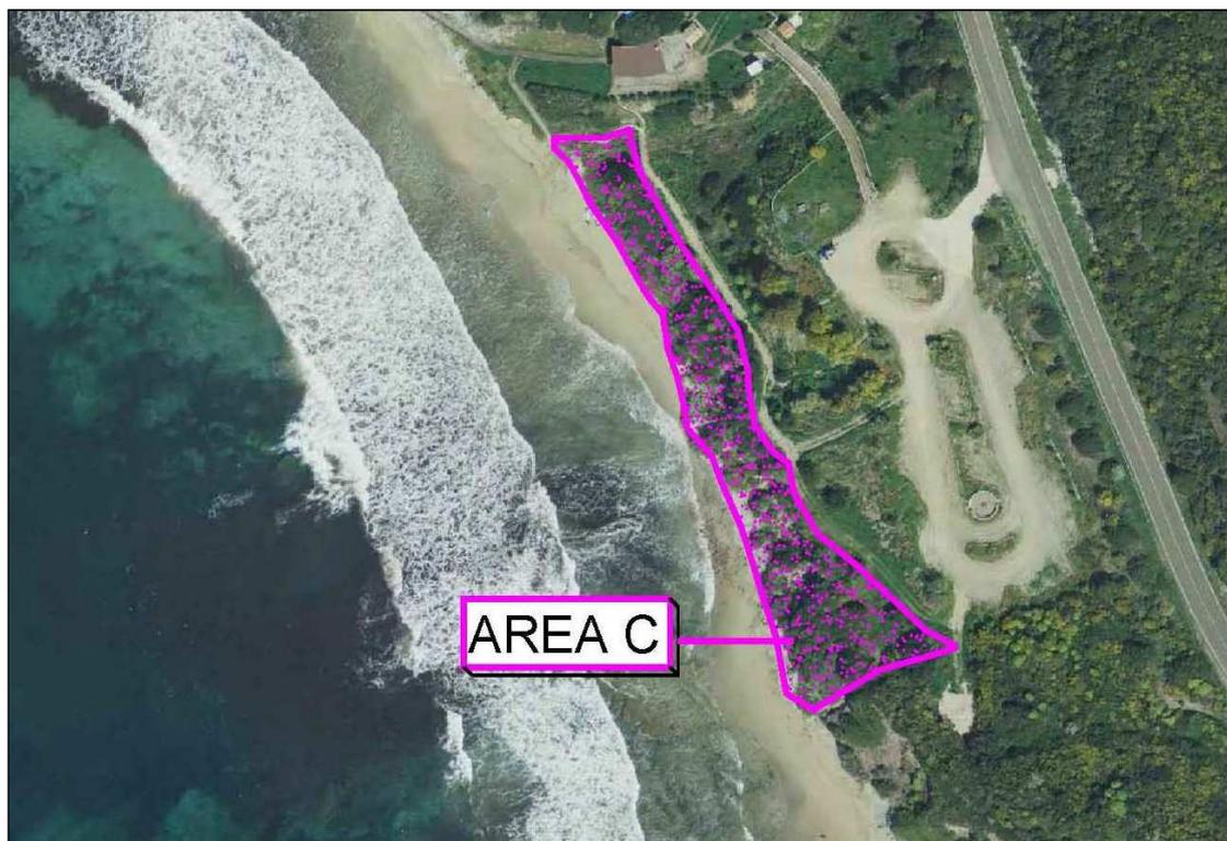
**Figura 11 - AREA C - versante con frane attive – dettaglio delle aree di intervento**
