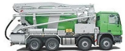
Questa soluzione viene utilizzata qualora si debbano usare quantità abbondanti di cemento in un cantiere che non è dotato di una betoniera fissa. Il bicchiere viene mantenuto in rotazione durante il trasporto; giunto in cantiere viene fatto ruotare in senso opposto e, sfruttando una coclea, il cemento risale le pareti e può fuoriuscire dalla sommità per essere gettato in opera.
